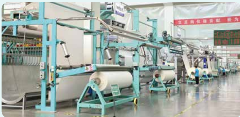
特宽幅印染生产线
